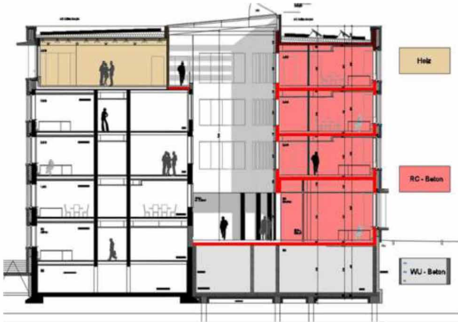
Abb. 11: Schnitt durch Altbau und Neubau mit der Aufstockung auf den Bestandsbau in Holzbauweise und Markierung der Bauteile aus RC-Beton im Neubau
