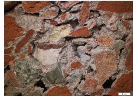
Abb. 17: Der historische Ziegelsplittbeton weist ein festes und intaktes Gefüge und keine Fremdsalzelastungen auf
